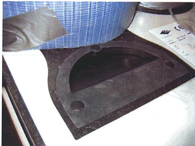
Bild 16: Teilweise geöffnete Aufteilklappe Umluft während der Frostschutzprüfung
